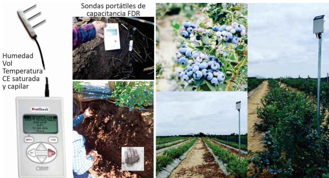
Figura 12. Sensores de humedad basados sondas capacitivas portátil; fijos y calicatas para el control de la humedad del suelo.
